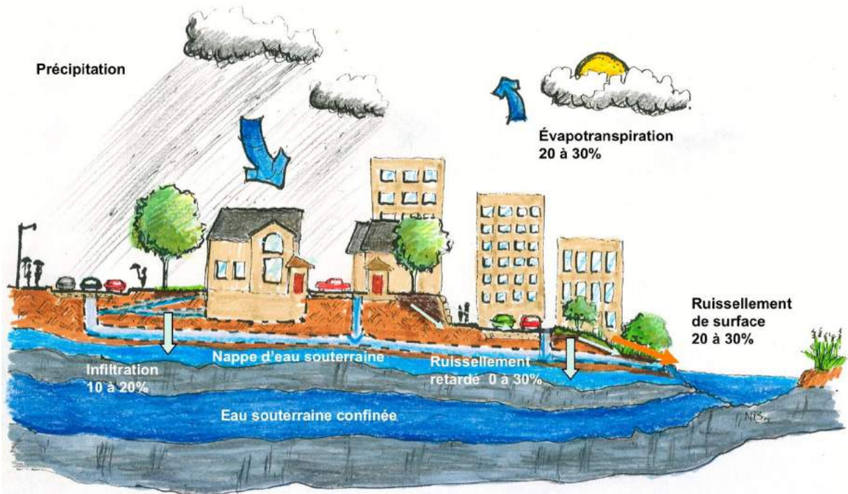
Figure 2. Cycle de l'eau d'un milieu urbain. Illustration : N. Bédard
