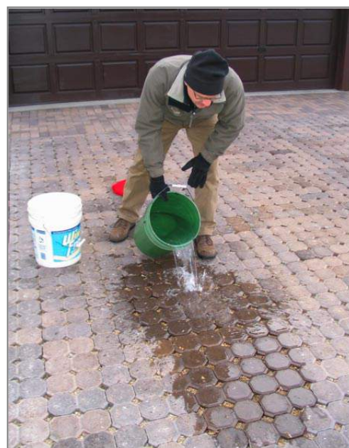
Pavé préfabriqué perméable démonstration University of Minnesota (2007)
