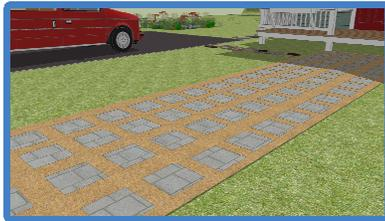
ces imperméables qui contribuent au ruissellement de l'eau de pluie vers les égouts. Les matériaux utilisés seront alors alvéolés ou poreux, dans le but de faciliter l'infiltration de l'eau dans le sol.
